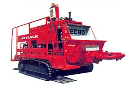
Raupenfahrwerk im Einsatz am Bohrgerät
